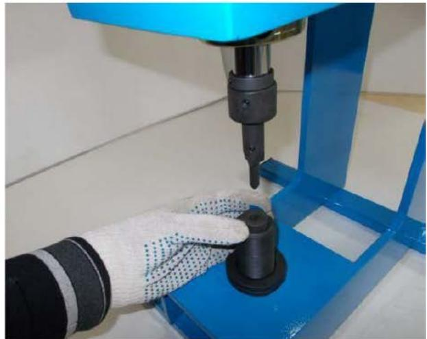
2. Используя пневмогидравлический насос станда, опустите гидравлический шток вниз и проверьте соосность пуансона и втулки друг относительно друга.
