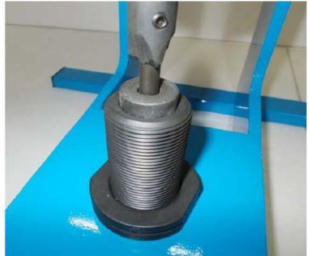
3. Для регулировки соосности необходимо совместить пуансон и опорную втулку, следующим образом: подвести пуансон к опорной втулке, при этом ослабить гайку ее крепления, совместить пуансон и затянуть гайку. После чего проверить надежность крепления цилиндра и опорной втулки.
