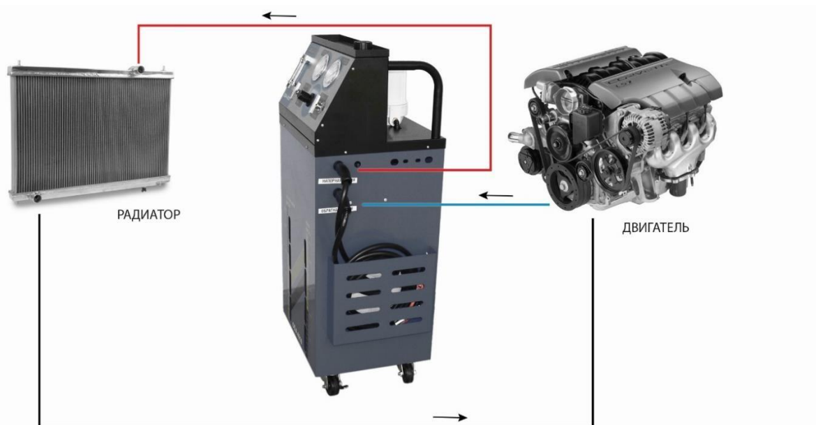
Рис. 3 Схема подключения изделия к системе охлаждения автомобиля
