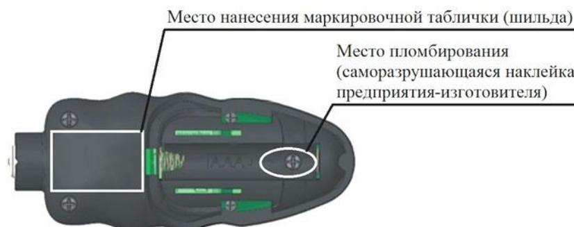
Рисунок 2 – Схема пломбировки от несанкционированного доступа
